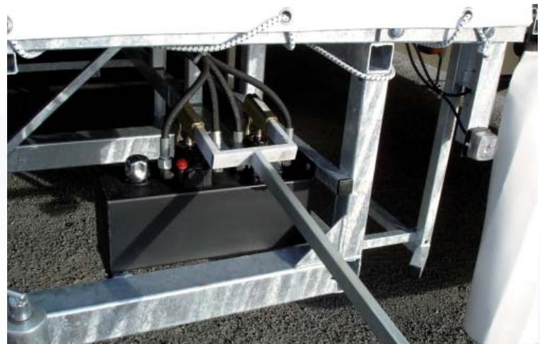
Système de pompage avec fourche permettant la levée de la toiture
