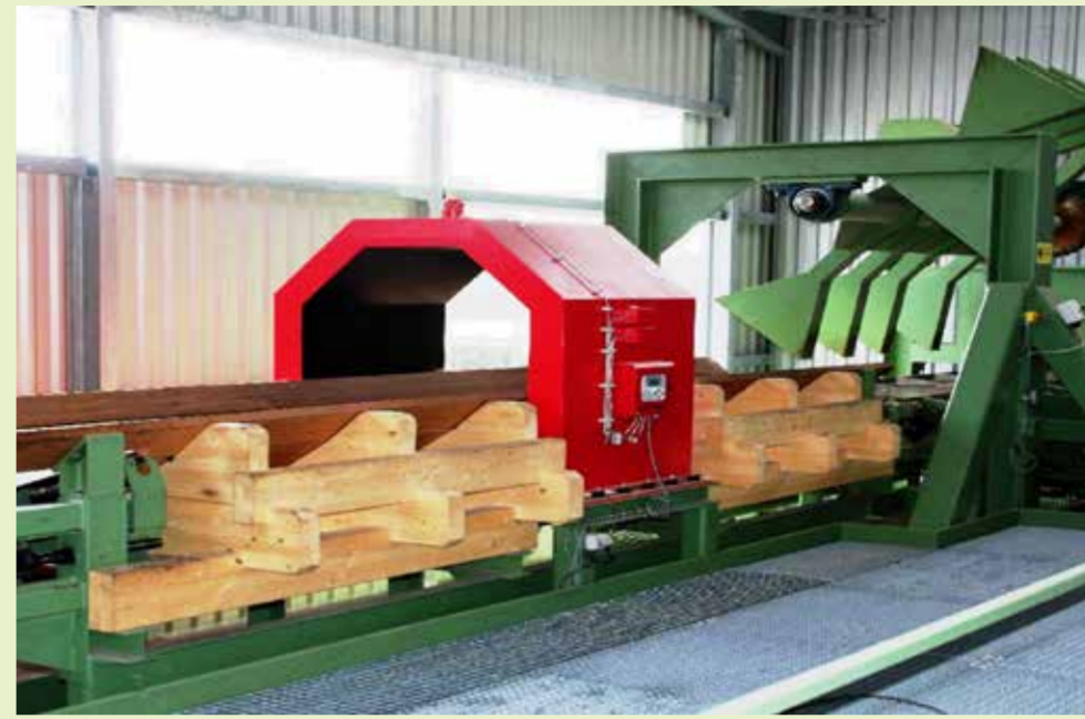
Un anneau de détection électromagnétique équipant un convoyeur dans une scierie. La bille testée avance dans l'anneau qui détecte et signale la présence de métal dans le bois.
